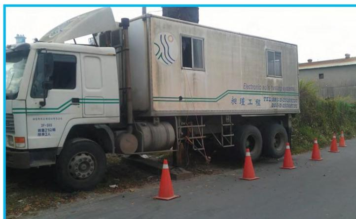
震測錐電子貫入試驗車內部（左）、鑽桿（右上）及外觀（右下）
